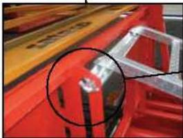
Veillez à ce que les ergots de l'échelle soit positionnés derrière les ronds de blocage.
